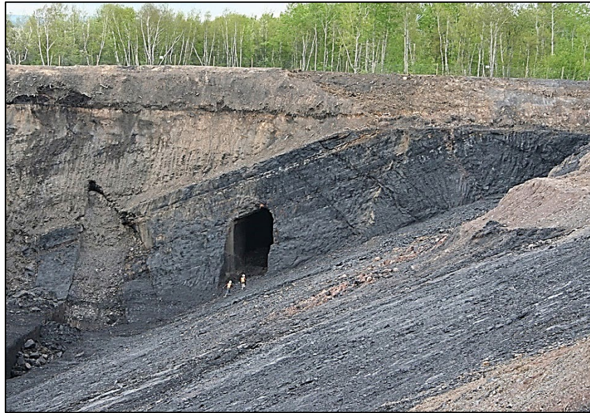
Abb. 5.2. Ein Tagebau-Kohlebergwerk in einem dicken, abfallenden Kohleflöz, das einen alten tiefen Bergbaustollen freilegt. Foord-Naht in der Stellarton-Formation aus dem Karbon, Stellarton, Nova Scotia, Kanada
