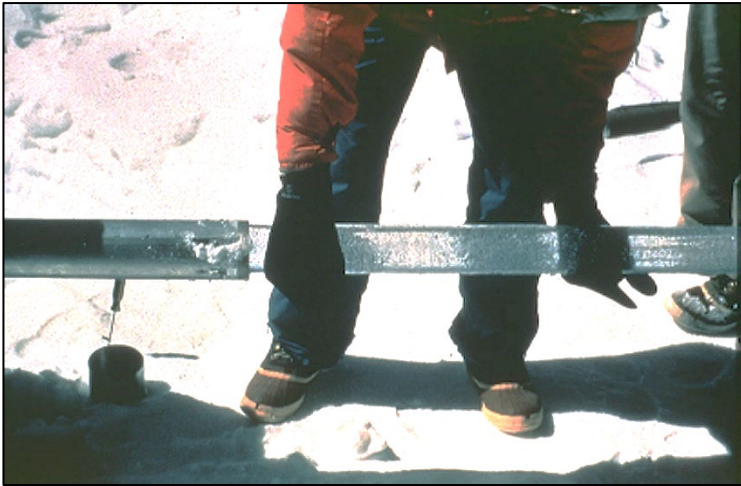
Abb.4.58. Entnahme eines Eiskerns aus einem Kernrohr einer Eisbohrung
