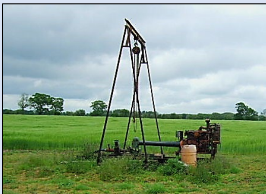
Heute im Einsatz befindliche Diesel-Grundwasserpumpe, England
