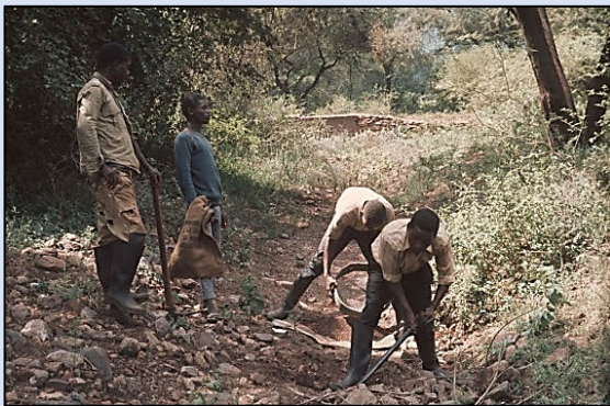
Entnahme einer Schwermineralprobe in einem ausgetrockneten Flussbett
