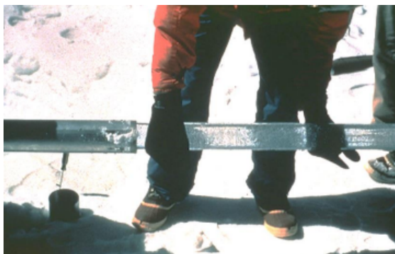
Figura 4.58. Extração de um núcleo de gelo de um tubo de núcleo retirado de um furo de sondagem de gelo
