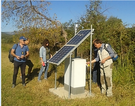
Equipamento de gravação para um de uma série de sismógrafo localizado em um buraco próximo, Golfo de Corinto, Grécia
