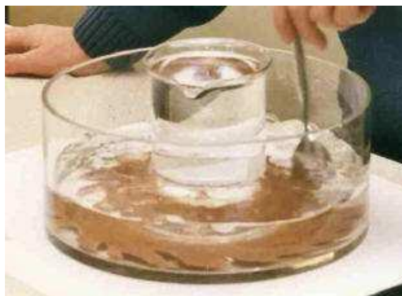
円形の洗面器で非対称のリップルマークをつくる様子
