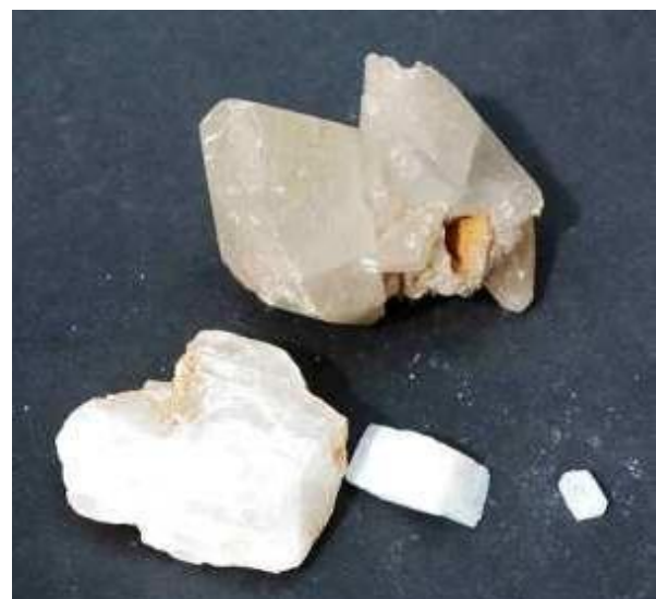
劈開：きれいな形の‘犬歯’状の方解石の結晶（上）と方解石の劈開した破片（下）
