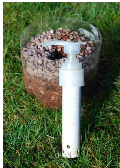
詰まるのを防ぐため、ポンプの筒に穴をあけた様子（“準備するもの”を参照）
