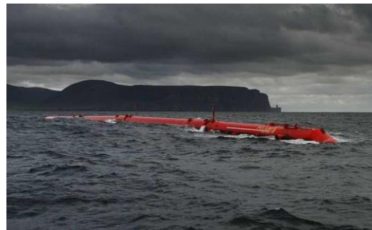
欧州海洋エネルギーセンター(EMEC)で試験されているペラムス波力発電装置
