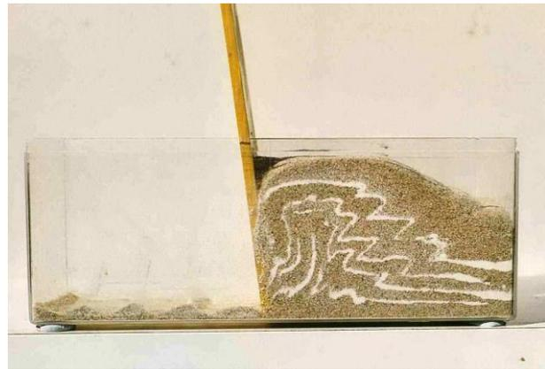
写真3：箱の中で再現した褶曲して断層が発達した地層模型
